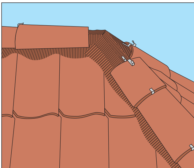
I modsatte ende af taget er rygningstenene på valmen monteret som tidligere beskrevet. Det er i denne ende at rygningstenene på den vandrette ryg evt. afkortes i længden.
